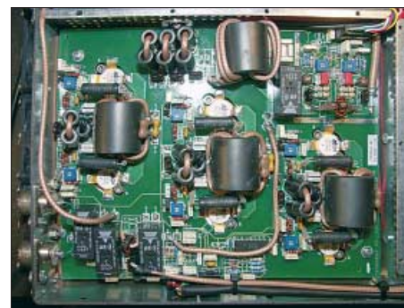
Bild 2: Unter der Haube: Der eigentliche HF-Teil besteht aus drei parallelgeschalteten Gegentaktendstufen. Fotos und Screenshots: DL3KH
