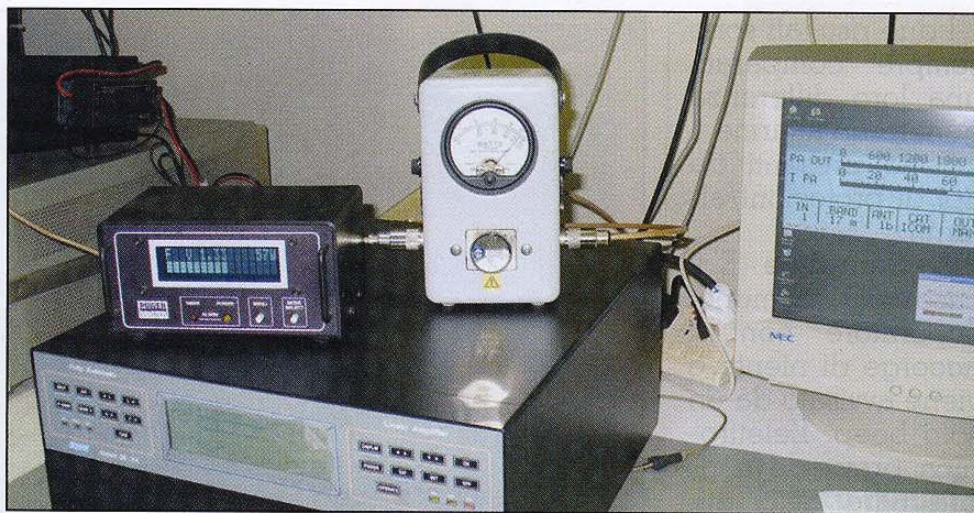
Misura delle potenze; a sinistra potenza dei pilotaggio, al centro potenza di uscita sul Bird con testina di 2500 watt f.s.; sullo sfondo il display connesso al 2K-FA
