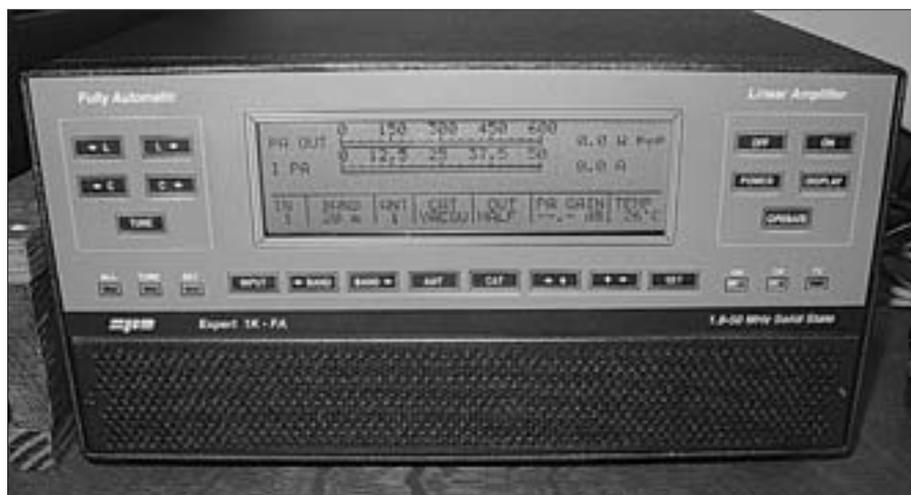
Foto A El amplificador lineal de estado sólido SPE 1K-FA proporciona 1000 vatios entre 160 y 10 metros y 700 vatios PEP en 6 metros.
