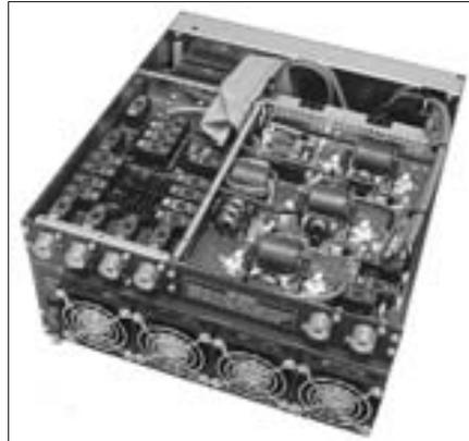
Foto C La parte de RF en la parte superior del lineal con las tapas de blindaje retiradas.
