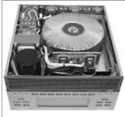
Foto B La parte inferior del amplificador muestra la fuente de alimentación, en la que destaca el transformador toroidal.
