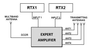
Questo è lo schema più generale dei collegamenti, se non si usa la SO2R non si collega l'antenna multi banda, se si ha un solo transceiver viene collegato un solo input. E' possibile anche usare, in luogo della multi banda, le varie antenne di stazione come spiegato successivamente.
