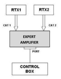
• IMPOSTAZIONE DI ANTENNE DI RICEZIONE : In alcuni casi potrebbe risultare utile trasmettere con una antenna e ricevere con un'altra più adatta allo scopo. Una funzionalità unica permette all'Expert di avere una gestione molto flessibile delle antenne disponibili. Ogni antenna può essere selezionata a) con funzione di RTX come default, b) la stessa antenna, contemporaneamente al caso precedente, può essere impostata come solo RX in altre bande, c) esclusivamente come RX (es, Beverage).
