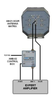
Questa unità non è semplicemente un "remote antenna switch" per 6 antenne per l'uso SO2R, ma ha anche la capacità di diventare una matrice  $1 \times 6$ , perfetta per remotizzare semplicemente fino a 6 antenne.
