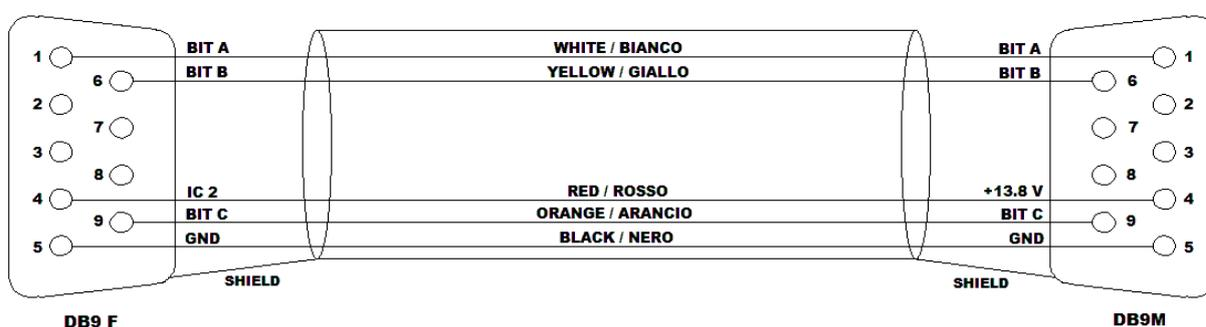
Nota: con questo cavo, nel caso di amplificatore Expert spento, la Matrice attiva automaticamente l'ANT1 in accordo con il manuale Expert.
