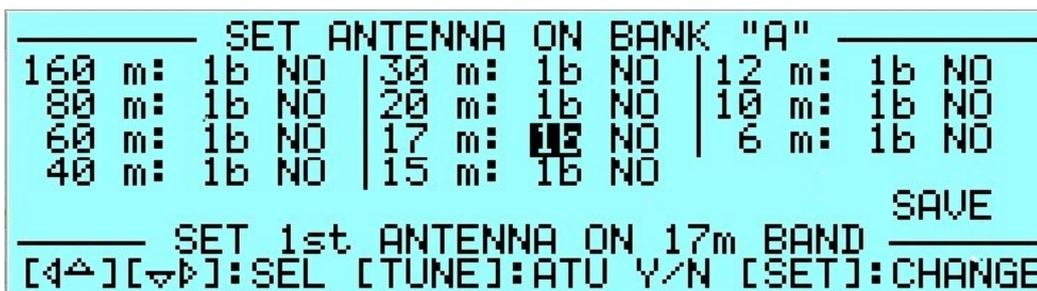
La programmazione permette di inserire fino a due antenne per la stessa banda. Ciascuna delle due antenne può essere selezionata, tramite il tasto [ANT], durante l'uso sia in modalità "STANDBY" che "OPERATE" ma non durante la trasmissione,
