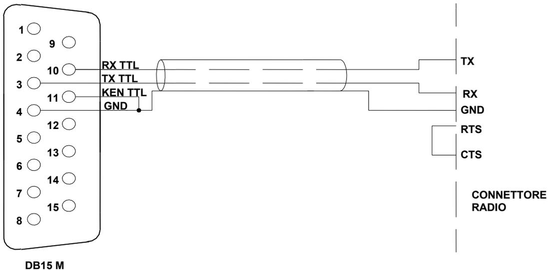
Il connettore radio viene descritto nello specifico manuale. Verificare se è necessario o meno il ponticello RTS-CTS.
