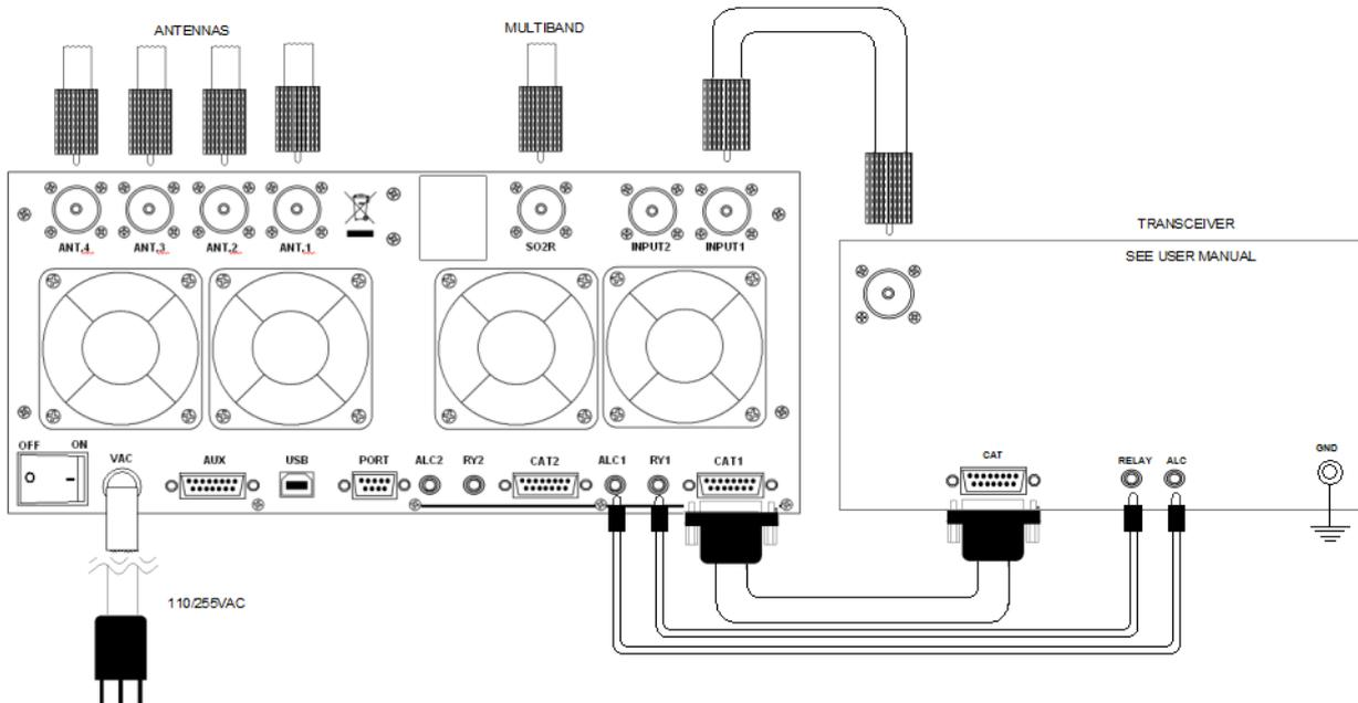
Vengono riportati i collegamenti con un solo transceiver, se si vuole collegare anche il secondo basta ripetere gli stessi collegamenti utilizzando il port "IN 2".
