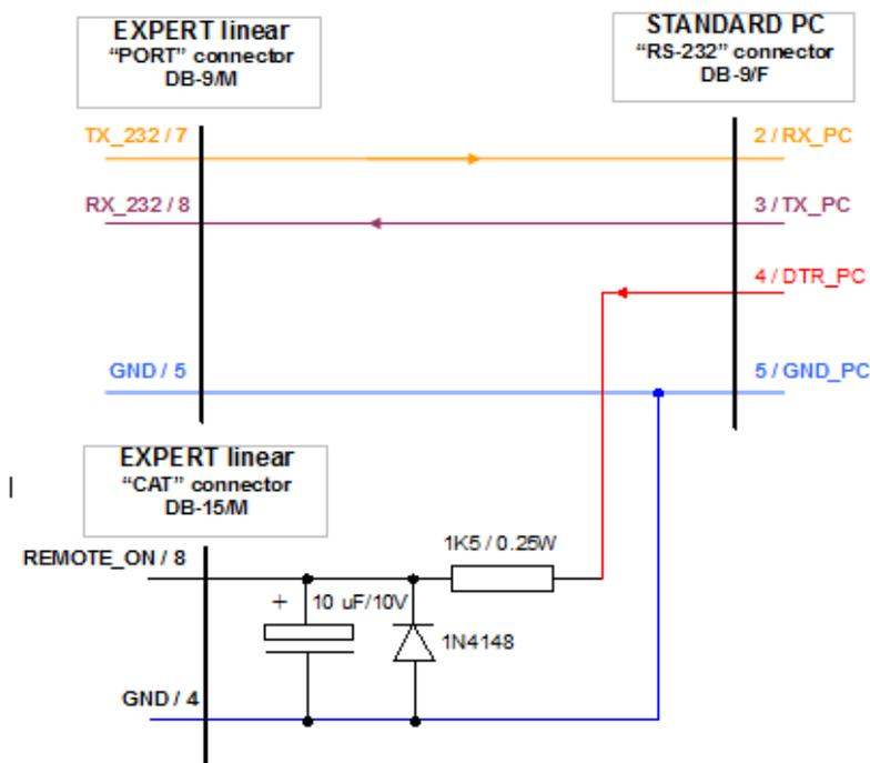
Cavo con cui è possibile controllare, accendere e spegnere l'amplificatore usando la porta RS 232
