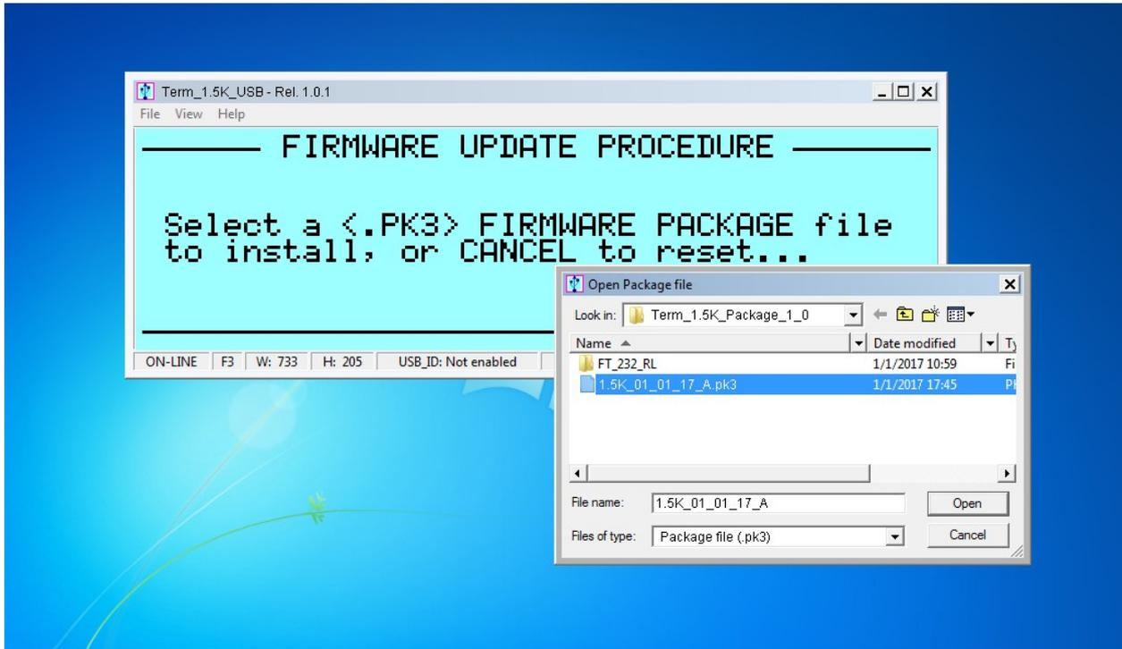
A seguito della necessaria conferma da parte dell'utente per convalidare l'operazione, l'**EXPERT 1,3K-FA** spegne il suo display LCD e l'intero controllo delle operazioni di aggiornamento viene trasferito all'applicazione **Term\_USB.exe / Term\_232.exe**.
