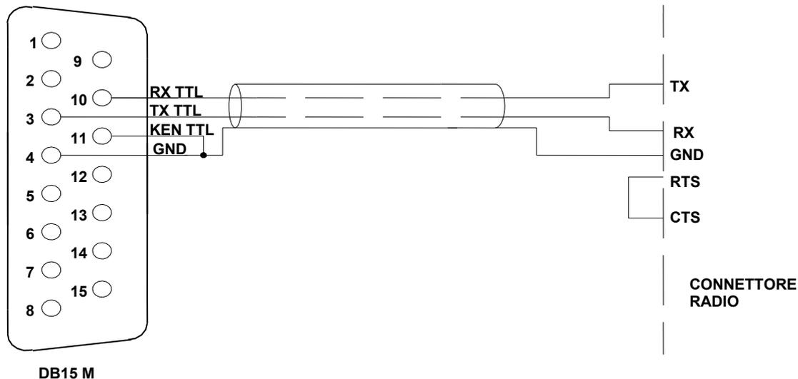
Il connettore radio viene descritto nello specifico manuale. Verificare se è necessario o meno il ponticello RTS-CTS.
