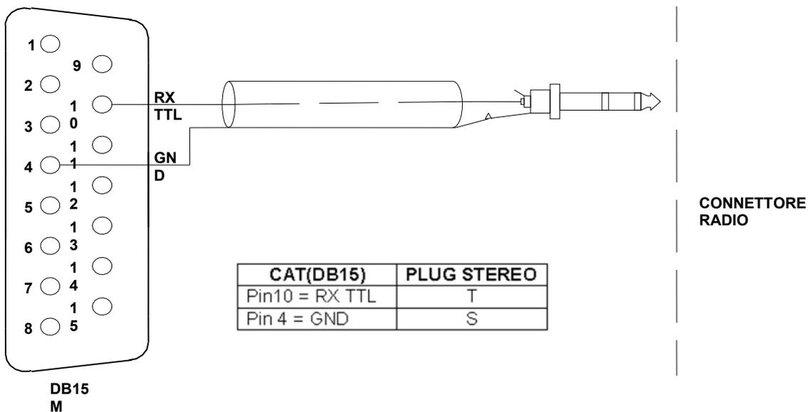
Questa interfaccia è standard per tutti i modelli Icom equipaggiati di CAT, il cavo termina sempre con un plug mono da 3,5 mm.
