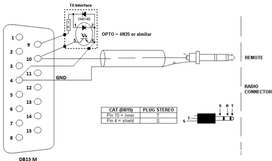
Utilizzando il cavo senza detta interfaccia (cavo standard) si avrà il trasferimento dei dati solo in presenza di un Software esterno che interroghi ciclicamente il transceiver (es. LOG in un PC) o quando l'operatore muove la manopola di sintonia o cambia banda.
