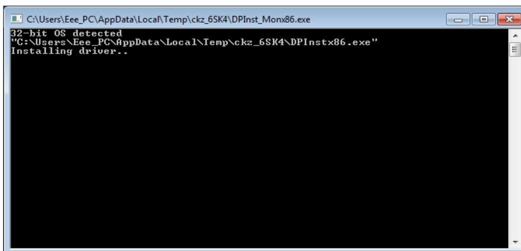
Il passo successivo consiste nel collegare il PC e l'EXPERT 1.5K-FA tramite l'apposito cavetto USB standard in dotazione ed attendere che la porta USB sia riconosciuta.
