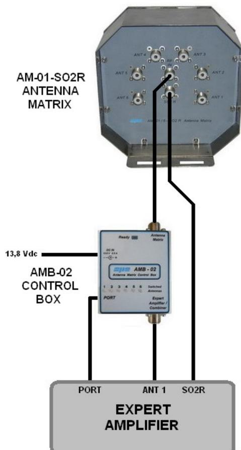
Questa unità non è semplicemente un "remote antenna switch" per 6 antenne per l'uso SO2R, ma ha anche la capacità di diventare una matrice 1 x 6, perfetta per semplicemente remotizzare fino a 6 antenne (nel caso il cavo SO2R non serve).
